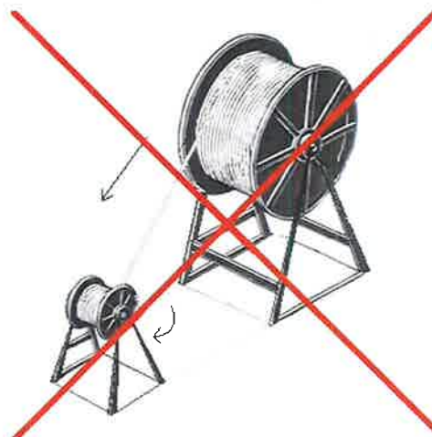
Rys. Błędny sposób przewijania kabla z bębna na inny bęben
