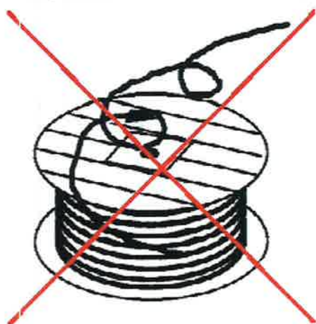
Rys. Błędny sposób odwijania kabla z bębna (ustawienie na jednej flanszy)
